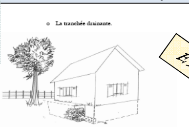
Fig. 5 : la tranchée drainante
