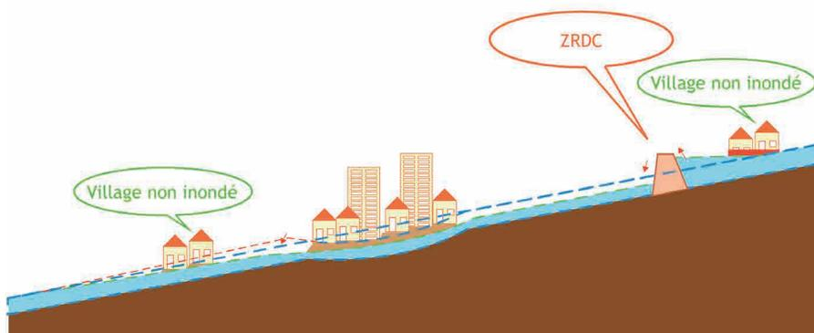
La Zone de Ralentissement Dynamique des Crues (ZRDC) permet de stocker l'eau à l'amont, diminuant ainsi les hauteurs d'eau à l'aval au niveau de la ville et du village.
