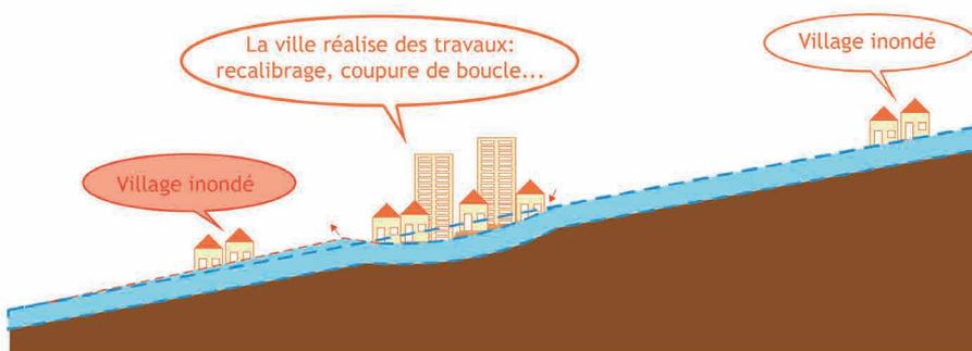
Les aménagements localisés réalisés par la ville permettent de diminuer les hauteurs d'eau localement. Mais ils provoquent une aggravation des inondations à l'aval en concentrant les écoulements.
