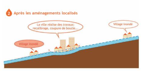
Les aménagements localisés réalisés par la ville permettent de diminuer les hauteurs d'eau localement. Mais ils provoquent une aggravation des inondations à l'aval en concentrant les écoulements.
